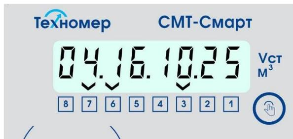
Рисунок 38 – индикация раздела «Режим передачи данных»
