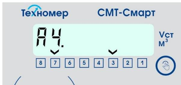
Рисунок 26 – индикация раздела «Предупреждения»
