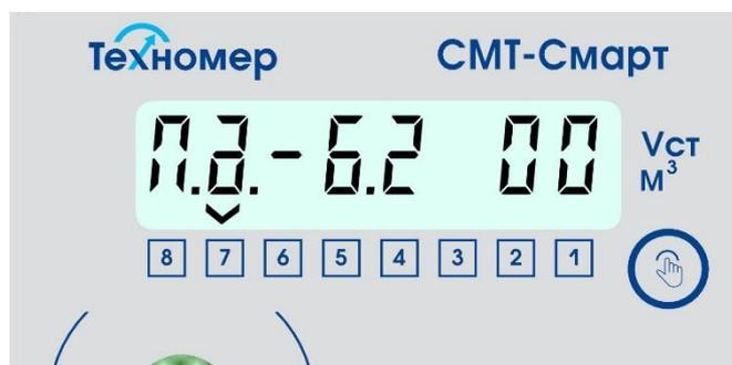
Рисунок 7 – Индикация неуспешного сеанса связи
