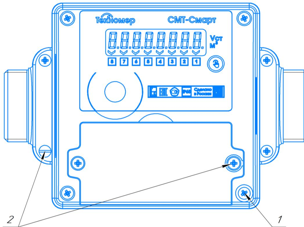
Рисунок 53 – Схема пломбировки СМТ-Смарт
