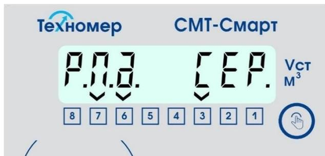
Рисунок 37 – индикация раздела «Режим передачи данных»
