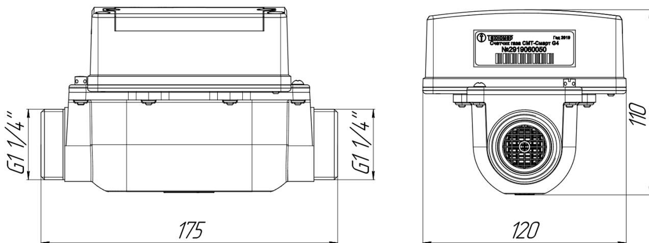
Рисунок А1 – габаритные размеры СМТ-Смарт G4 (G6)
