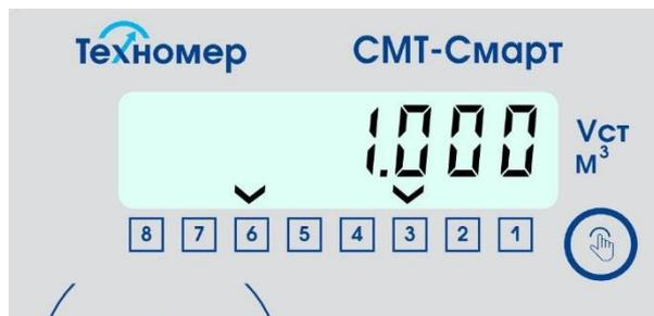
Рисунок 19 – индикация целой части раздела «Стандартный возмущенный объем газа» в технологическом меню объема
