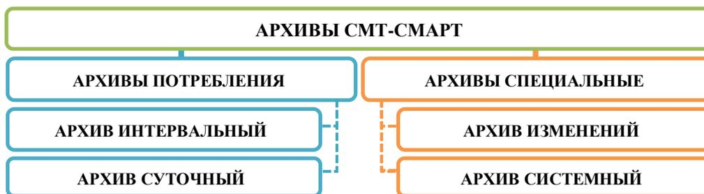
Рисунок 52 – структура архивных данных СМТ-Смарт
