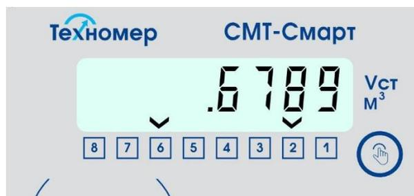
Рисунок 19 – индикация дробной части раздела «Стандартный объем газа» в технологическом меню объема
