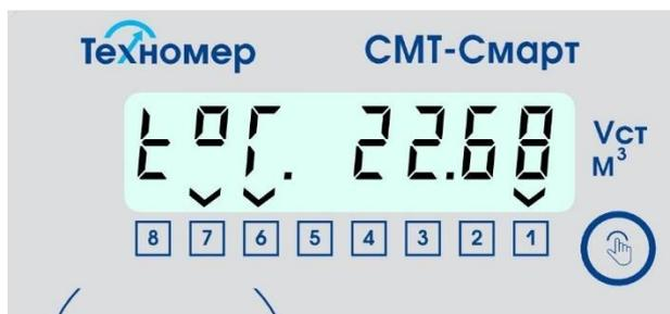
Рисунок 33 – индикация раздела «Температура газа» (температура газа 22,68°C)
