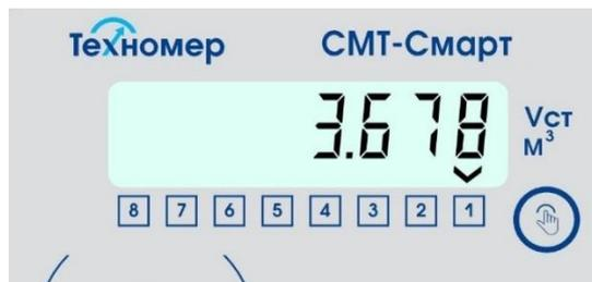
Рисунок 11 – индикация раздела «Стандартный общий объем газа» в основном меню
