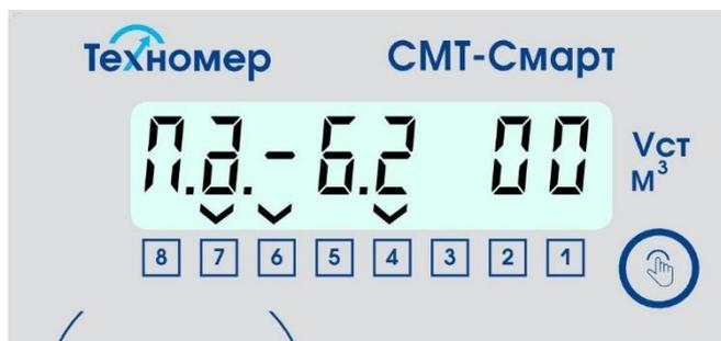
Рисунок 41 – Индикация неуспешного сеанса связи
