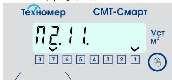
Рисунок 22 – индикация раздела «Предупреждения» (активны предупреждение П2 и П11)
