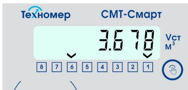
Рисунок 16 – индикация целой части раздела «Стандартный общий объем газа» в технологическом меню объема
