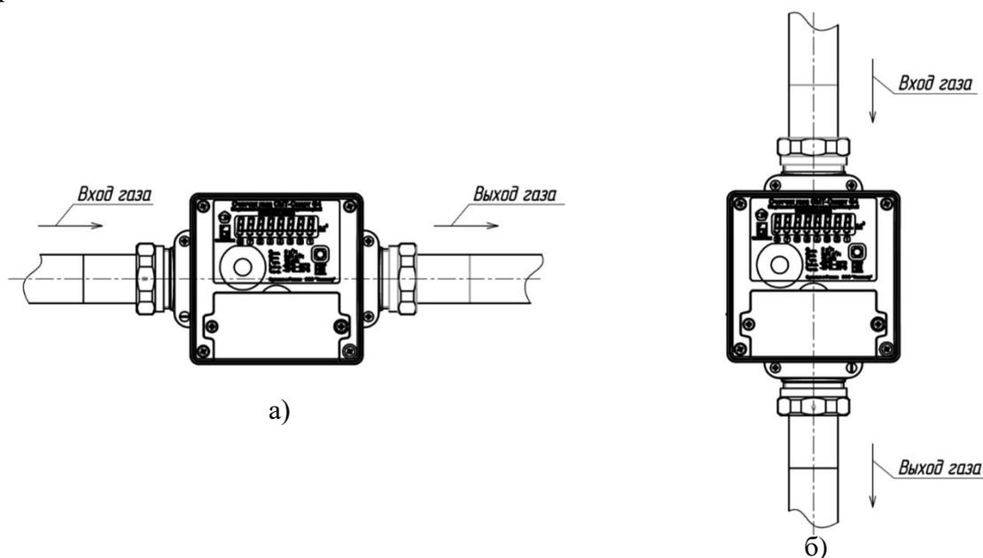
Рисунок Б2 – пример монтажа СМТ-Смарт в отапливаемых помещениях.
