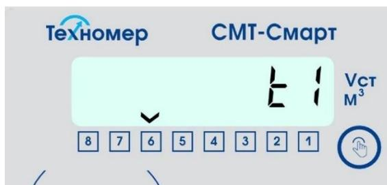
Рисунок 14 – индикация раздела перехода в «Технологическое меню объема»
