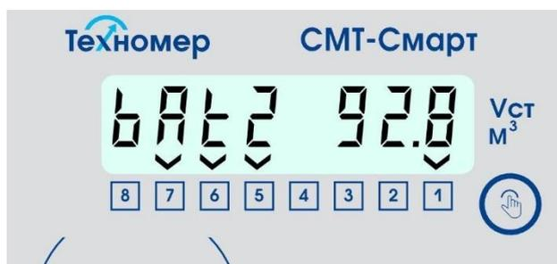
Рисунок 43 – Индикация раздела «Состояние основной батареи счетчика»
