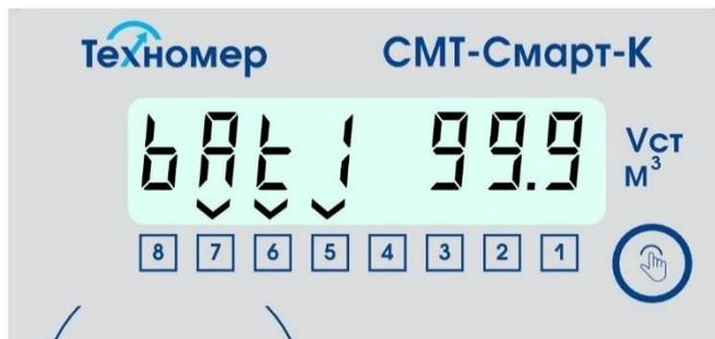
Рисунок 42 – Индикация раздела «Состояние резервной батареи счетчика»
