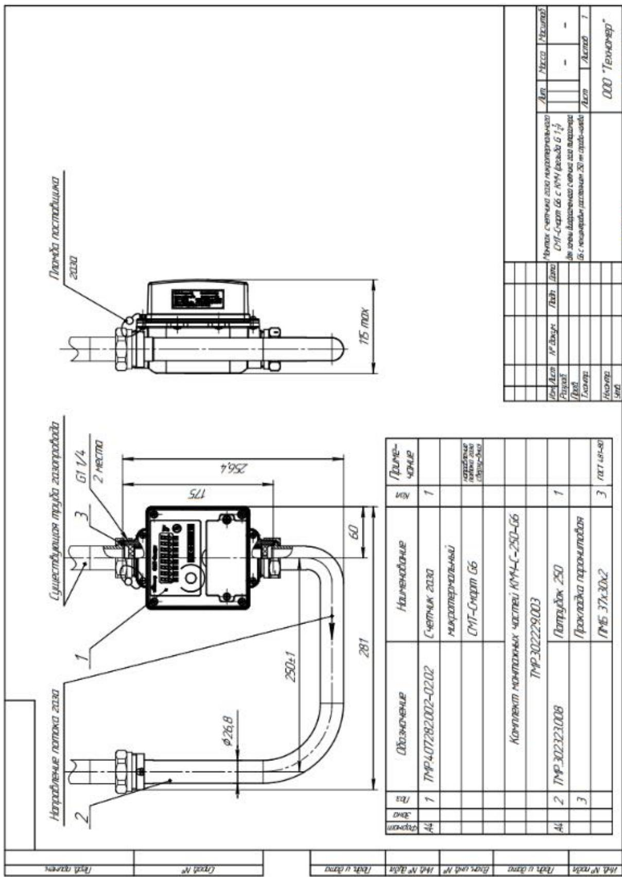
Рисунок Б5 – монтаж СМТ-Смарт G6 взамен диафрагменного счётчика G4 с межцентровым расстоянием 250 мм и присоединительными штуцерами резьбой G1 1/4 дюйма.
