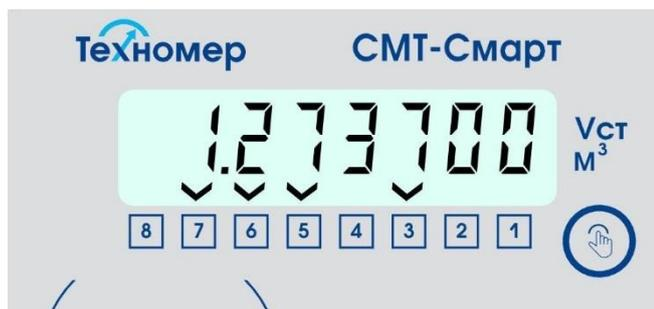
Рисунок 46 – Индикация раздела «Версия программного обеспечения»
