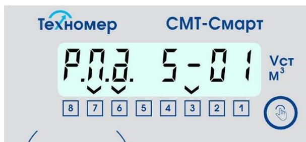
Рисунок 35 – индикация раздела «Режим передачи данных» (5 – режим передачи (декадный), -01 -день внутри декады 1й (1, 11, 21 числа каждого месяца))
