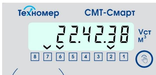
Рисунок 34 – индикация раздела «Время» (текущее время прибора 22 часа 42 минуты 38 секунд)
