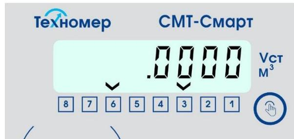
Рисунок 20 – индикация дробной части раздела «Стандартный объем газа» в технологическом меню объема
