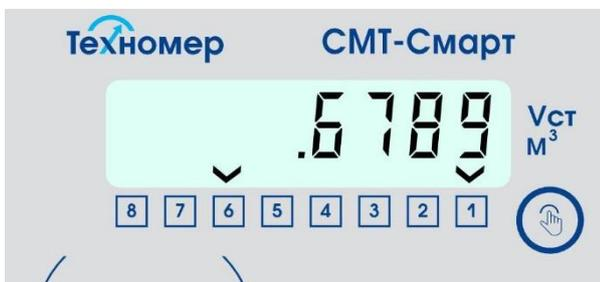
Рисунок 17 – индикация дробной части раздела «Стандартный общий объем газа» в технологическом меню объема
