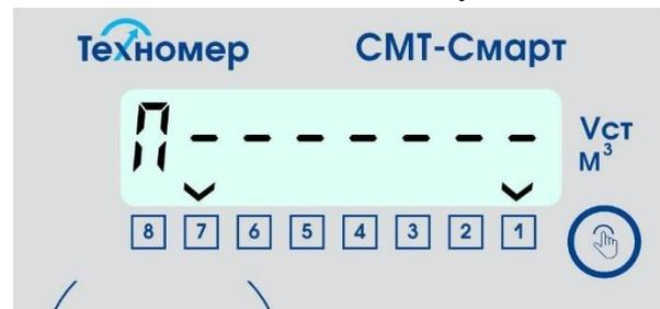
Рисунок 21 – индикация раздела «Предупреждения» (предупреждений нет)
