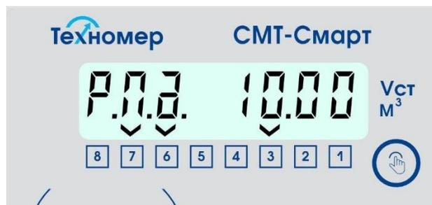
Рисунок 36 – индикация раздела «Режим передачи данных» (время сеанса связи в декадном режиме - 10:00)
