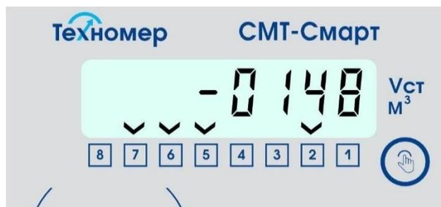
Рисунок 45 – Индикация раздела «Серийный номер. Вторая часть» (версия)
