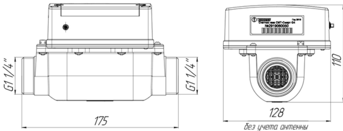
Рисунок А3 – габаритные размеры СМТ-Смарт G4 (G6)-B
