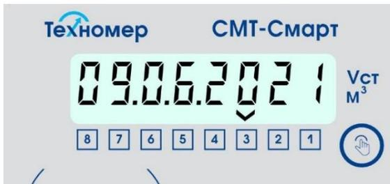
Рисунок 13 – индикация раздела «Дата прибора»
