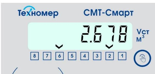
Рисунок 18 – индикация целой части раздела «Стандартный объем газа» в технологическом меню объема
