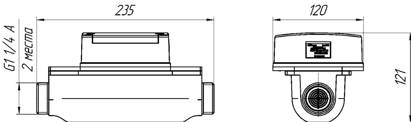
Рисунок А2 – габаритные размеры СМТ-Смарт G10
