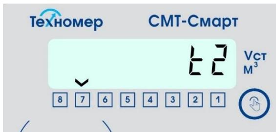
Рисунок 15 – индикация раздела перехода в «Технологическое меню»
